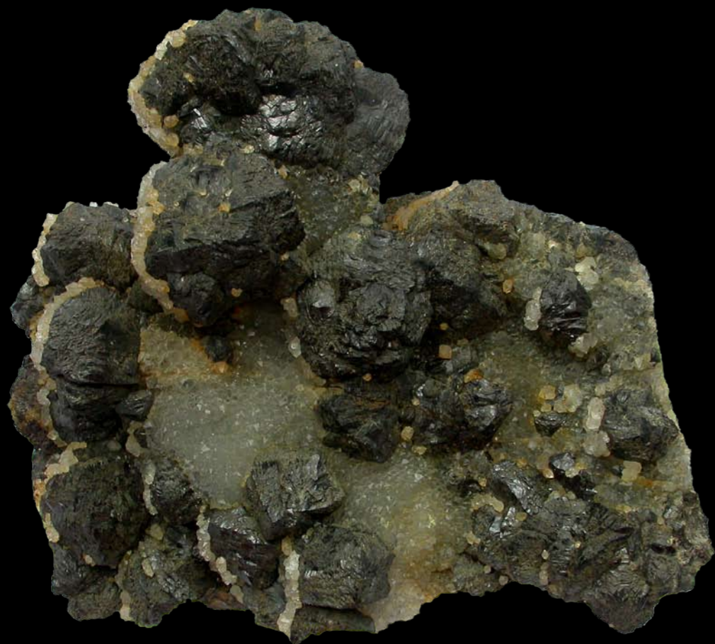
13. Mnohonásobné srostlice krystalovaného sfaleritu na křemenu, Dlouhá žíla, K273, velikost vzorku 13 x 11 cm, sbírka Z. Navrátil
